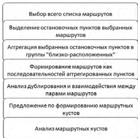
Рисунок 3 – Схема выделения маршрутных кустов для планирования и лотирования
