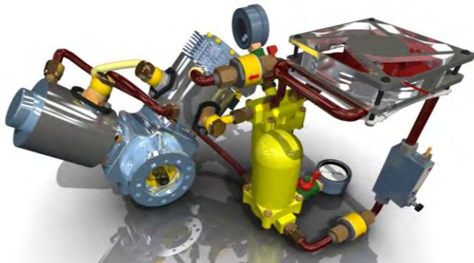
Рисунок 1 – Система охлаждения компрессора
