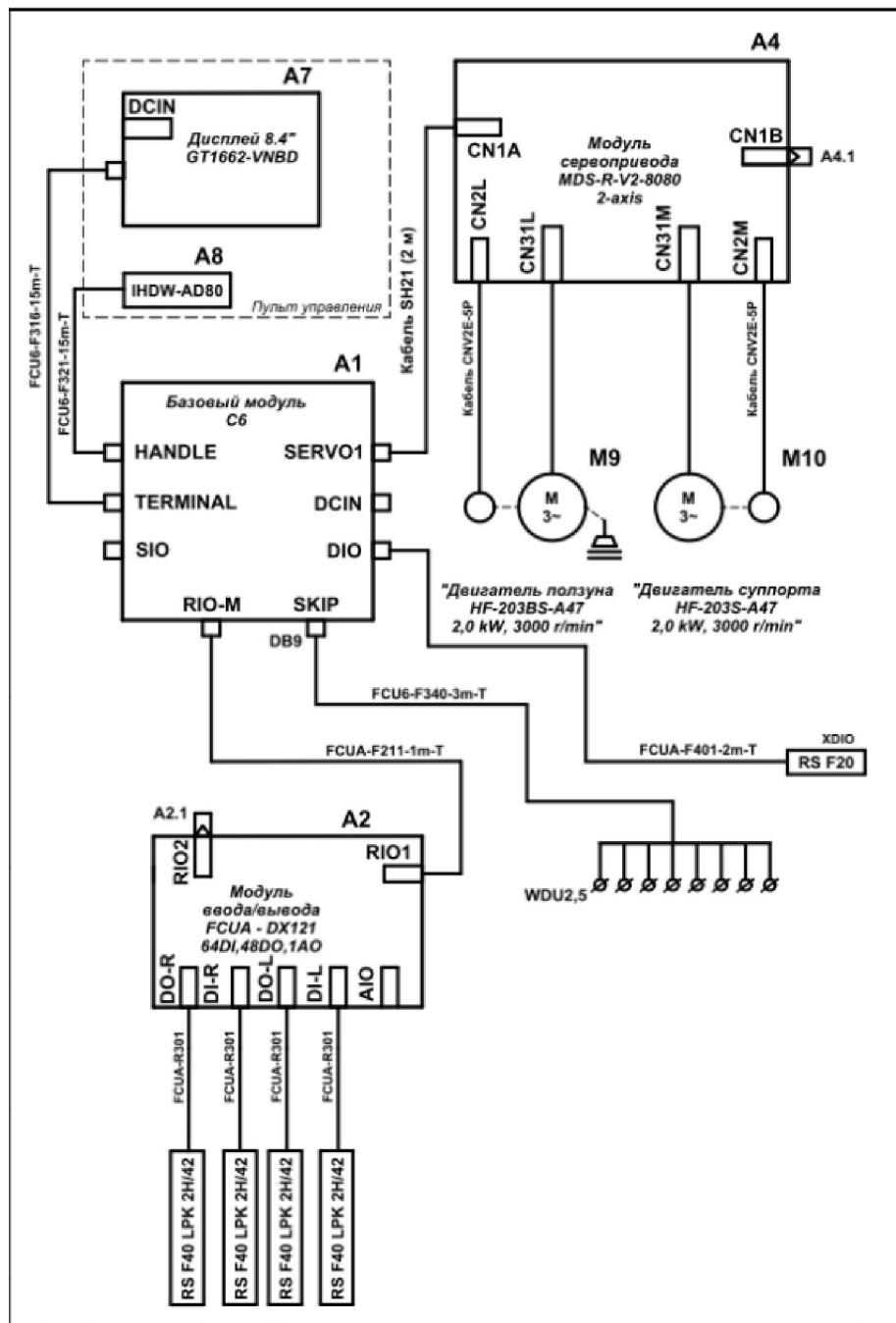
Рисунок 1. Структурная схема системы управления координатно-шлифовального станка «Bertheiz»
