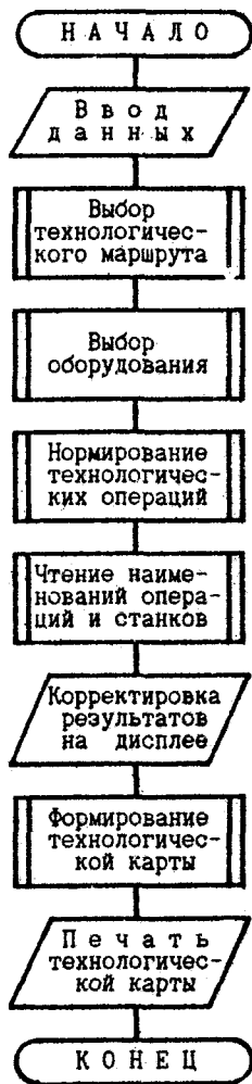
Рис. 7.2.1. Схема алгоритма проектирования маршрутного технологического процесса изготовления режущего инструмента
