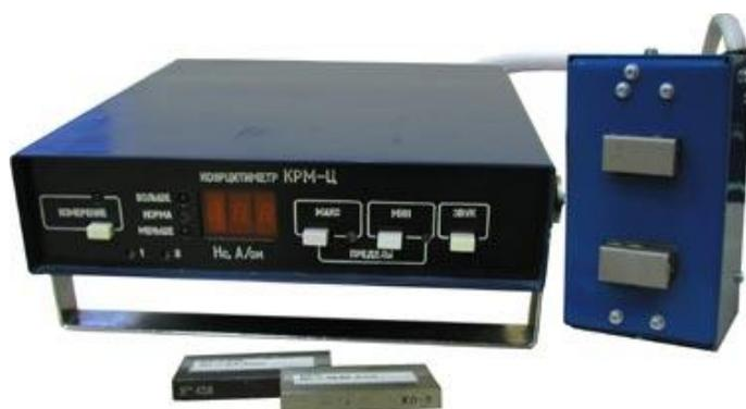
Рис 3.38. Магнитный структуроскоп – коэрцитиметр КРМ-Ц
