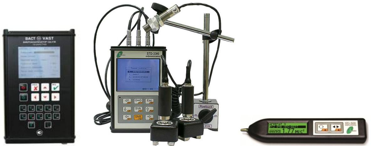
Рис.5.5. Переносные вибронализаторы разных производителей
