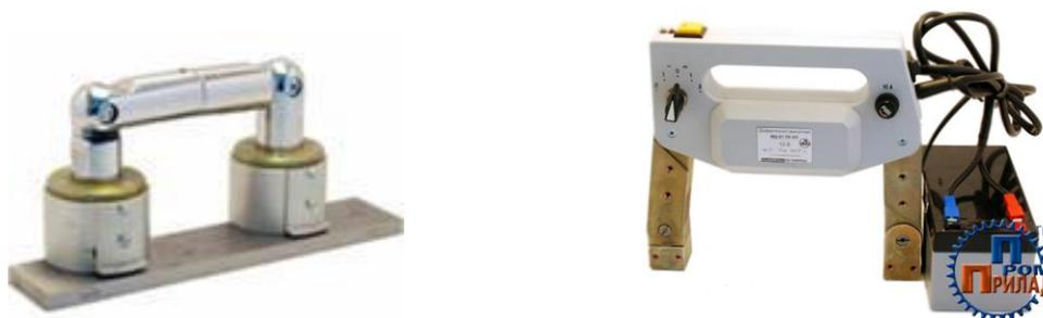
Рис. 3.32. Магнитный дефектоскоп МД-4К и МД01-ПК
