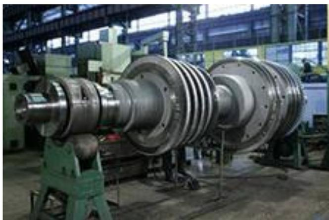
*Рис. 4.6. Установка ротора на козлах*
