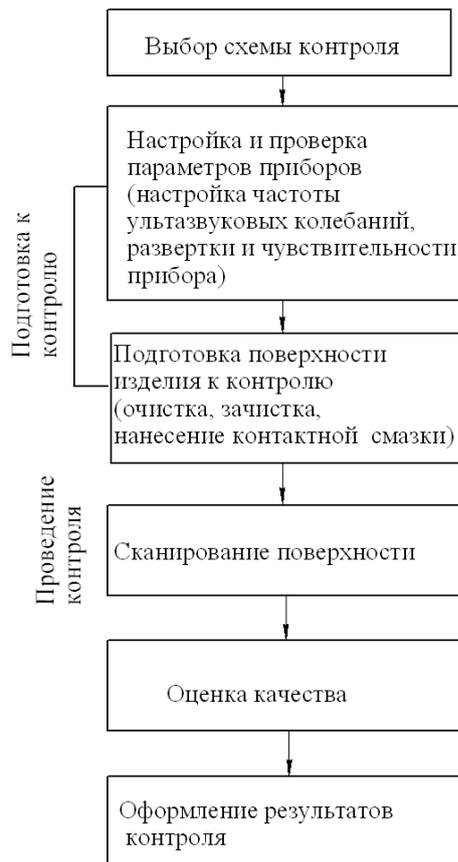
Рис. 3.5. Технология проведения контроля ультразвукового контроля
