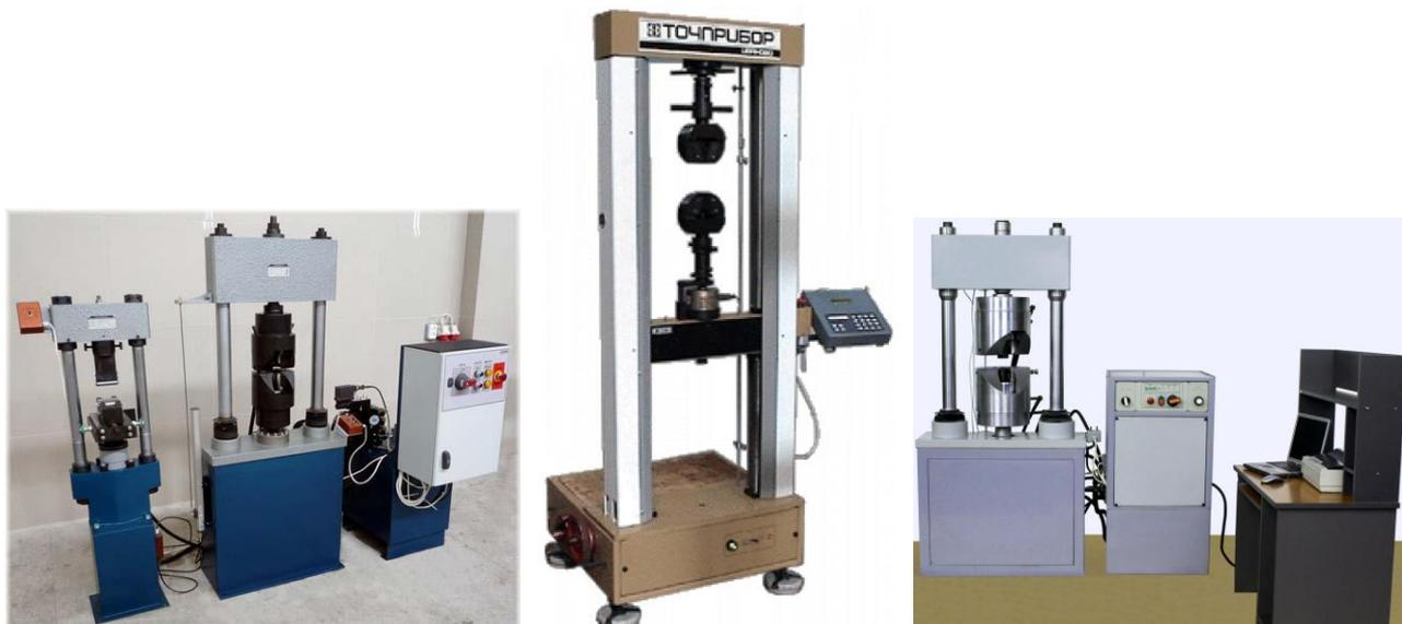
Рис.2.4. Внешний вид испытательных разрывных машин разных производителей.
