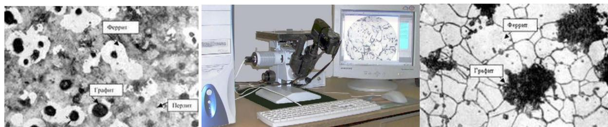
Рис.20. Изучение микроструктуры сталей и сплавов
