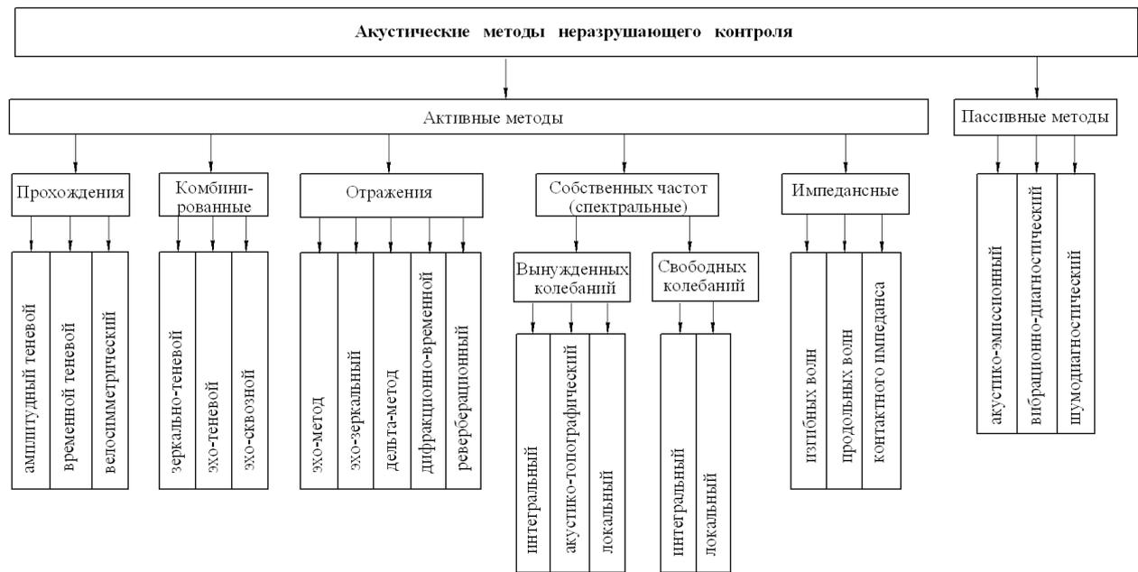
Рис.3.3. Классификация методов акустического контроля
