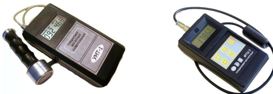
Рис. 3.35. Толщиномеры магнитные УМТ-1 и МТЦ-3
