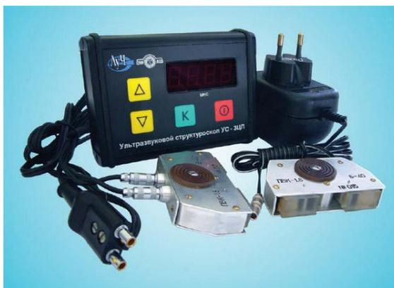
Рис. 3.36. Ультразвуковой структуроскоп УС-3ЦЛ
