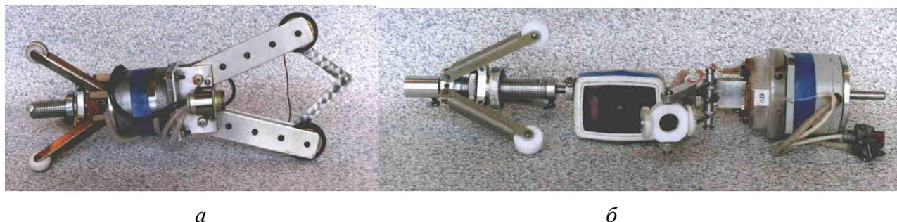
Рис.6.1. Универсальный транспортный механизм с блоком управления для перемещения модулей поисковых систем внутри осевого канала (а), вихретоковый и визуально-оптический сканирующий модуль (б)
