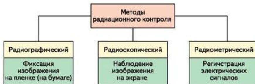
Рис. 3.20. Классификация методов радиационного контроля
