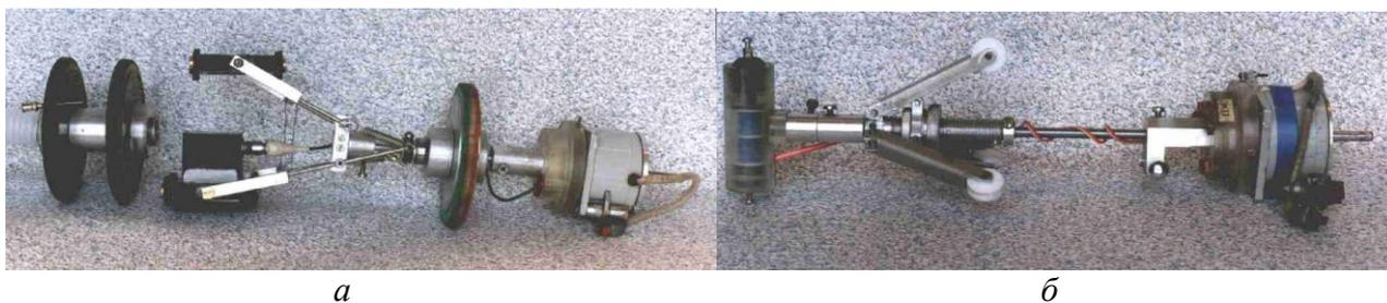
Рис.6.2. Ультразвуковой сканирующий модуль (а), модуль измерения диаметра осевого канала и оценки остаточной деформации металла (б)
