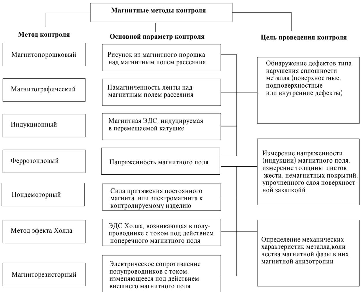
Рис.3.11. Классификация магнитных методов контроля по способам регистрации магнитных полей рассеяния
