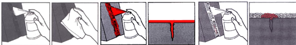
Рис. 3.16. Технологический процесс капиллярного контроля
