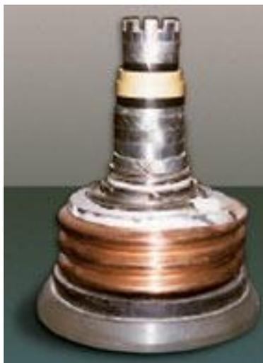
Рисунок 3. HTСП-кабель на 3 ГВА (разработка ВНИИКП).
