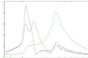
Рисунок 2 – Резонансные характеристики ВП ЛГ в трехосевом БЛГ
