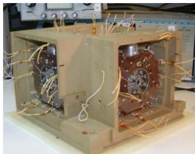
Рисунок 4 – Блок чувствительных элементов с тремя ЛГ
