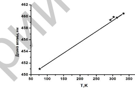
Рисунок 3 – Зависимость длины волны, на которую приходится максимум спектра от температуры окружающей среды
