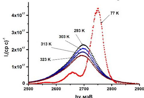
Рисунок 1 – Зависимость спектральной силы излучения СИД от энергии фотонов
