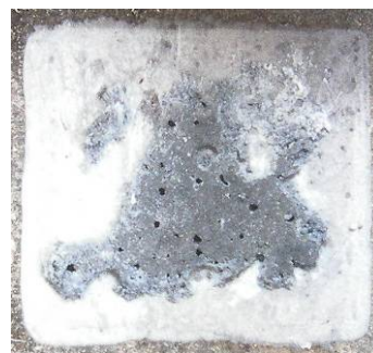
Рисунок 5 – Дефекты в припое под кристаллом после травления кремния
