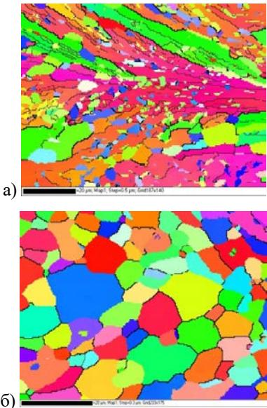
Рисунок 2 – Зеренная структура фольг сплава (SnIn)Bi<sub>8</sub>: - а-сторона, прилегающая к кристаллизатору, б- свободно затвердевающая сторона
