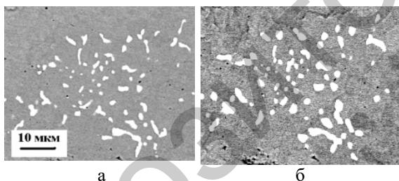
Рисунок 1 – Микроструктура поперечного сечения фольги сплава (SnIn)Bi<sub>8</sub> после выдержки при  $T_{\text{ком}}$  в течение 30 ч (а) и 150 ч (б)
