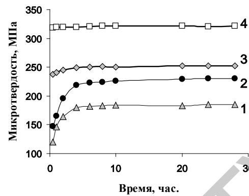
Рисунок 3 – Зависимость микротвердости фольг сплавов (SnIn)Bi<sub>x</sub> от времени выдержки при комнатной температуре и от содержания висмута: 1-X=0; 2- X=2; 3- X+4; 4- X=8 ат.%
