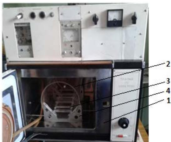
Рисунок 1 – СВЧ плазмотрон резонаторного типа
