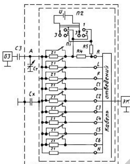
Рисунок 4 – Схема определения коэффициента ослабления синфазных сигналов
