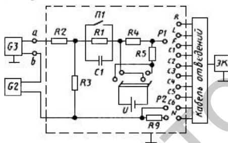
Рисунок 2 – Схема проверки нелинейности и эффективной ширины записи (изображения) канала
