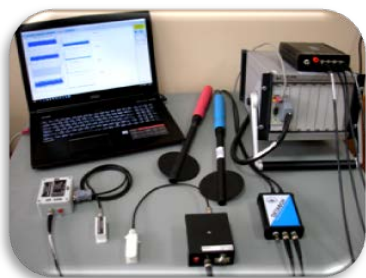
Рисунок 1 – Блок регистрации электрических и магнитных полей
