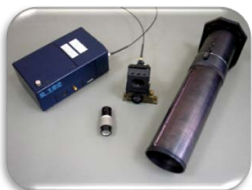
Рисунок 2 – Блок регистрации спектров оптического излучения
