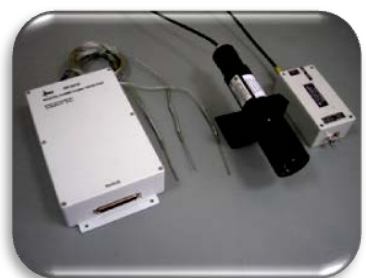
Рисунок 3 – Блок регистрации температур
