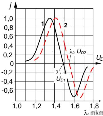
Рисунок 2 – Спектральная характеристика чувствительности двухбарьерного фотоприемника ( $Ni-nGe(Cu)-Ni$ )
