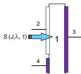
1 – полупроводник; 2 – полупрозрачный контакт Шоттки; 3 – тыльный контакт Шоттки; 4 – управляющий электрод
