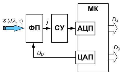
Рисунок 3 – Измерительный преобразователь с фотоприемником компенсационного типа
