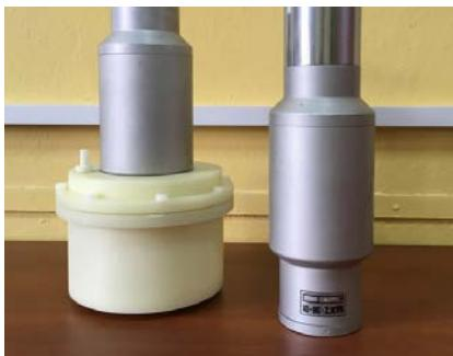
Рис. 3. Сцинтилляционный блок БДЭГ 2-38 помещенный в прокачиваемый герметизированный сосуд Маринелли (слева). БДЭГ 2-38 изображен справа
