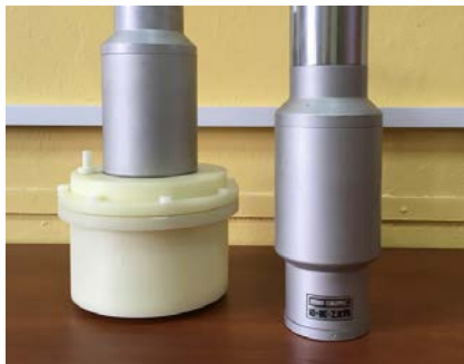
Рис. 3. Сцинтиляционный блок БДЭГ 2-38 помещенный в прокачиваемый герметизированный сосуд Маринелли (слева). БДЭГ 2-38 изображен справа
