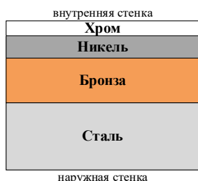
Рисунок 1 – Структура многослойной стенки камеры сгорания ЖРД
