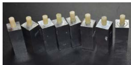
Рисунок 2 – Внешний вид фиксаторов-держателей с закрепленными образцами из КМ
