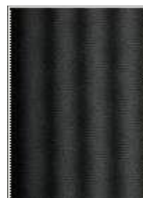
Рисунок 5 – Изображение графитовых стержней в обратнорассеянном рентгеновском излучении
