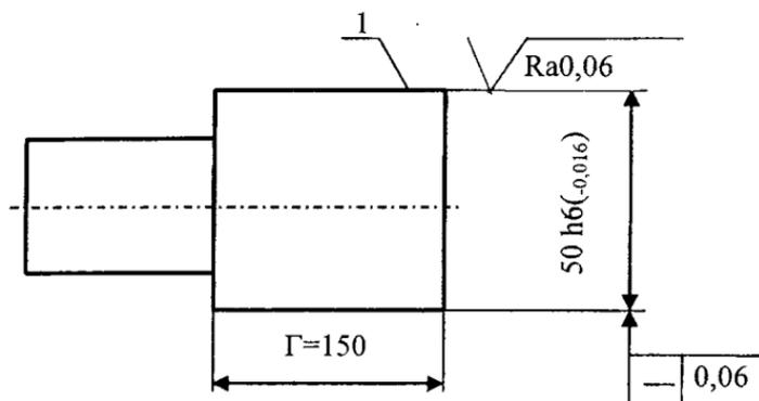
2. Материал детали – сталь 40X, ГОСТ 4543-71, 45-50 HRC, заготовка – штамповка обычной точности, получаемый после штамповки размер  $\varnothing 54$ .
