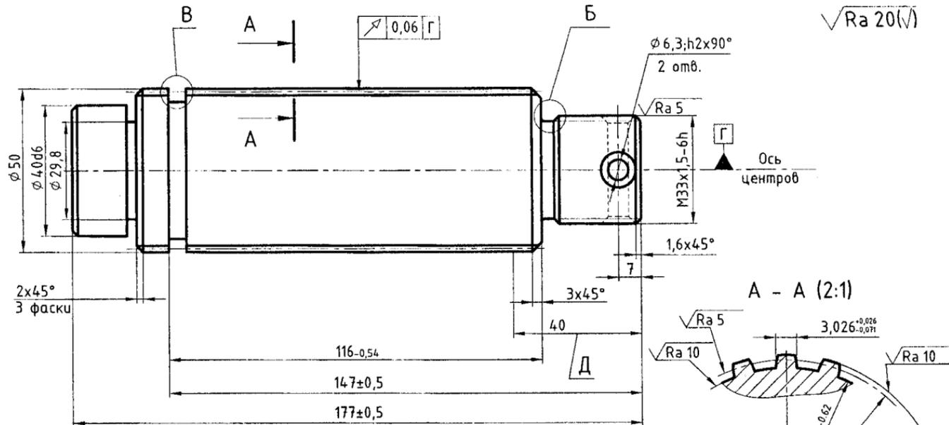
1. Цементировать  $h\ 1,0...1,5\text{мм}$  59...65 HRC. Участок Д от цементации предохранить
