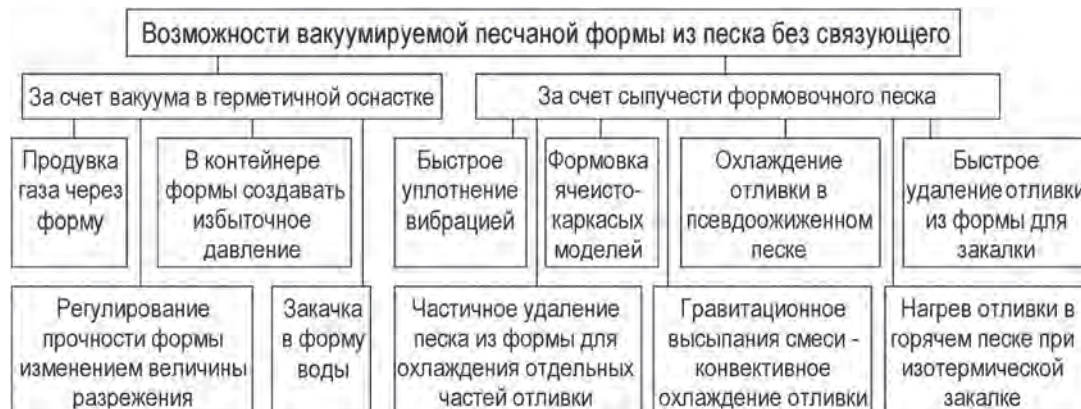
Рис. 4. Технологические возможности вакуумируемой песчаной формы в герметичной опочной оснастке, содержащей сыпучую песчаную среду
