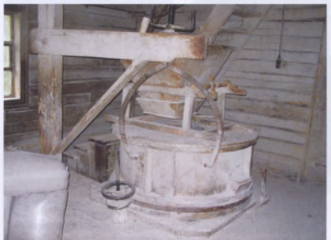
Рис. 4. Жернова и устройство для их подъема в водяной мельнице в Пруде Зельвенского р-на
