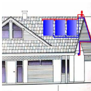
Рис. 1.2. Конструкция небольшой гелиосистемы с естественной циркуляцией теплоносителя в контуре гелиоколлектора – двухконтурная схема с гидравлическим разделителем и нижним расположением бойлера [2, 3, 4, 14]
