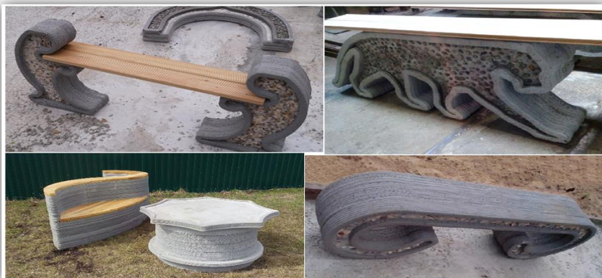
Рис. 7. Элементы благоустройства, выполненные на строительных 3-D принтерах первым способом формования.
