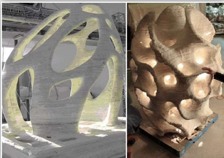
Рис. 8. Малые архитектурные формы, выполненные на строительном 3-D принтере D-Shape третьим способом формования
