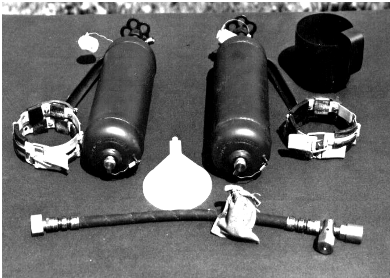
Рис. 48 Танковый дегазационный прибор
