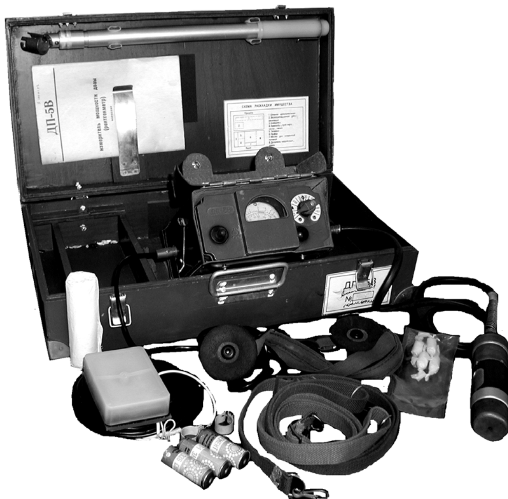
Рис. 25 Измеритель мощности дозы ДП-5В
