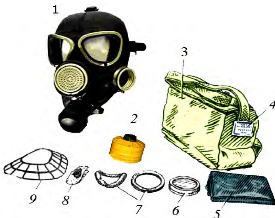
Рис. 32 Противогаз ПМК: 1 - маска М-80; 2 - фильтрующе-поглощающая коробка ЕО-1.08.01 в чехле; 3 - сумка; 4 - бирка; 5 - водонепроницаемый мешок; 6 - незапотевающие пленки; 7 - накладные утеплительные манжеты; 8 - крышка фляги с клапаном в полиэтиленовом пакете; 9-вкладыш
