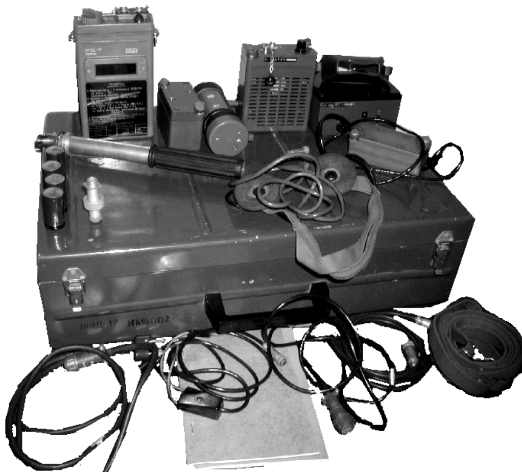
Рис. 26. Измеритель мощности дозы ИМД-1
