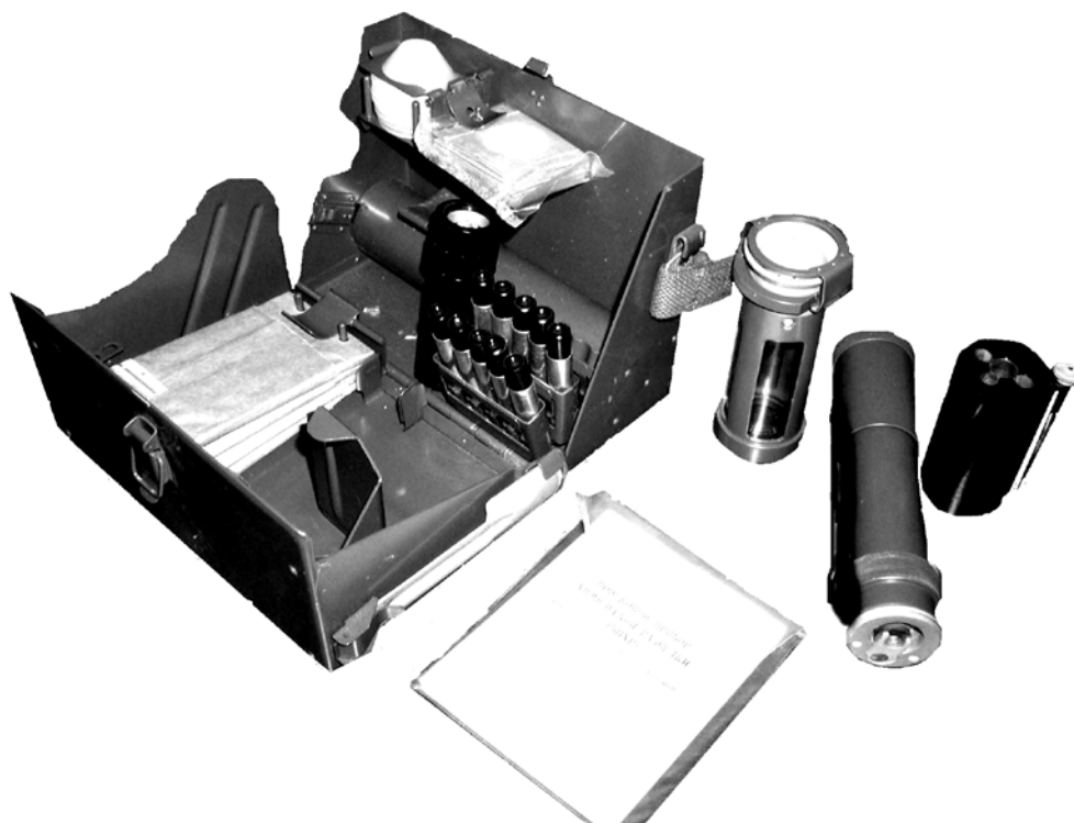
Рис. 29 Войсковой прибор химической разведки ВПХР
