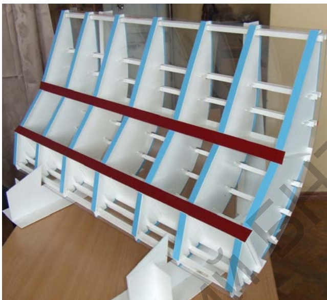
Рисунок 1 – Макет гидротехнического сегментного затвора
