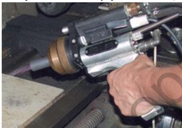
Рисунок 14 – Установка ТЕРКО-ПШ для нанесения покрытий распылением полимерных шнуров (экструдатов)
