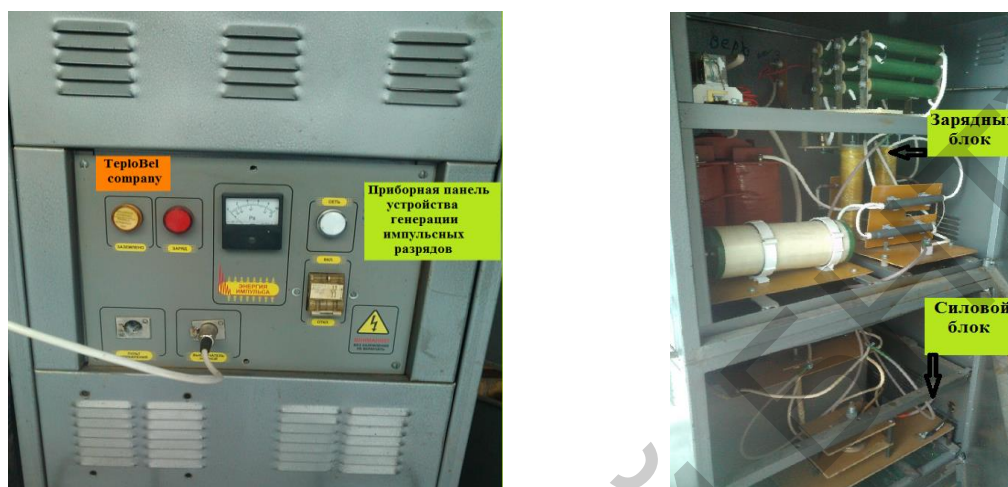
Рисунок 4.5. – Внешний вид устройства, преобразующего энергию в импульсы тока микросекундной длительности для электрогидравлической обработки нефтесодержащих отходов
