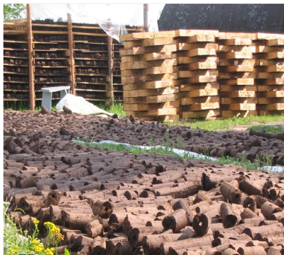
Рисунок 4.9. – Исследования процесса сушки в естественных условиях
