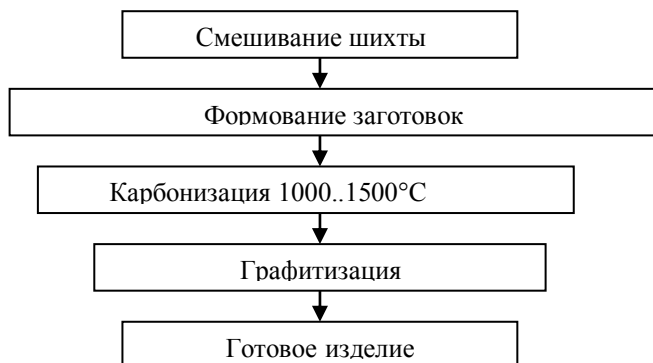
Рисунок 1 – Схема получения композиционного материала на основе порошка графита
