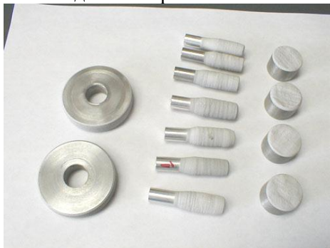
Рисунок 3 – Детали из алюминиевого сплава Д16 с микродуговым покрытием
