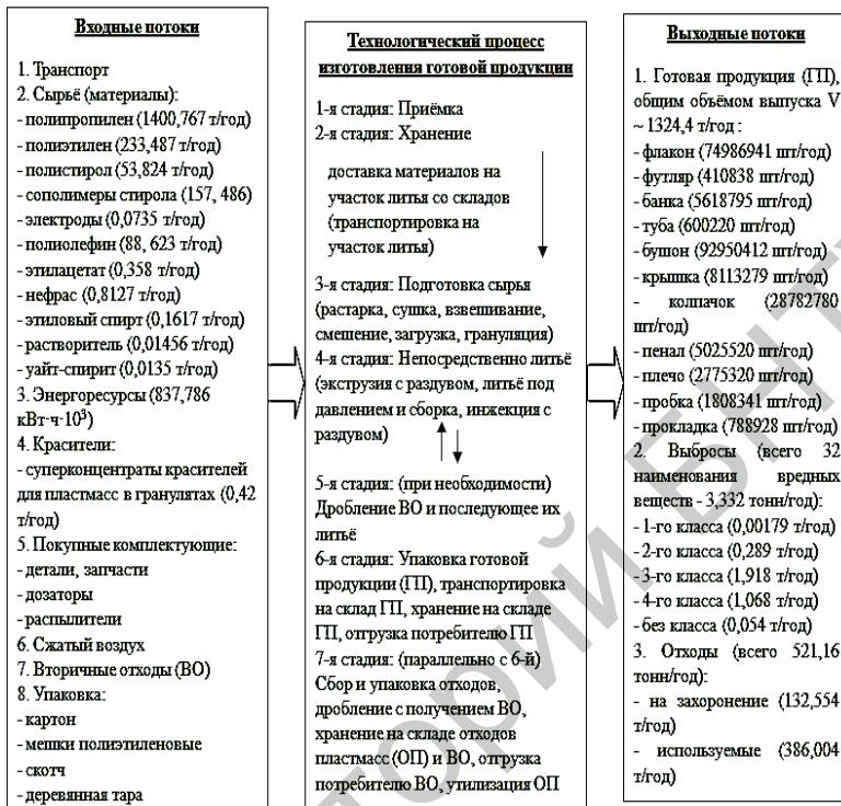
Рисунок 1 – Схема материально-энергетических потоков предприятия ООО «МИТРА»
