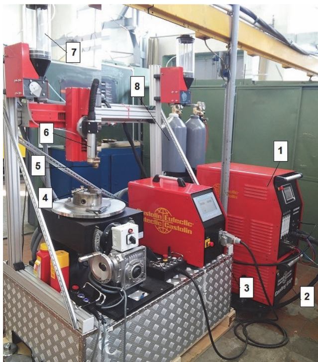
Рис. 1. Оборудование плазменно-порошковой наплавки компании Castolin Eutectic: 1 – блок управления, источник тока EuTronic GAP 2001 DC Touch Screen; 2 – охлаждающие устройства Cooling GAP; 3 – блок управления перемещения; 4 – деталь для наплавки; 5 – плазматрон GAP IMPA 100; 6 – горелка GAP E42; 7 – емкость для порошка; 8 – баллоны с газом
