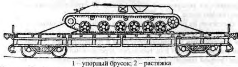
Рисунок 15 – Закрепление военной гусеничной машины с помощью растяжек и упорных брусьев
