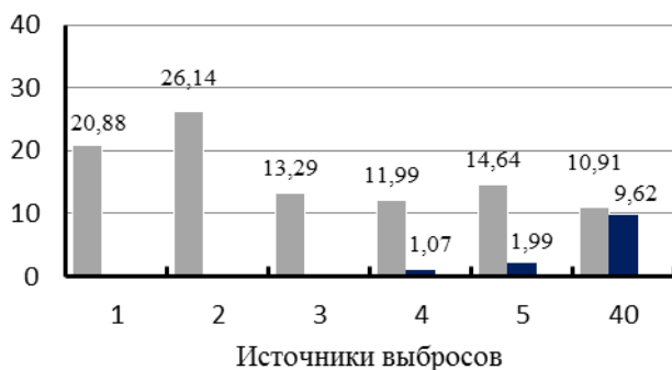
Рис. 2. Сравнительная диаграмма выбросов загрязняющих веществ до (□) и после внедрения модульного фильтра (■)
