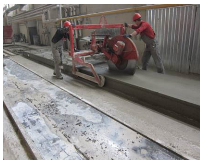
Рисунок 3. Технология изготовления плит безпалубочного формирования
