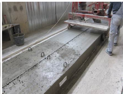
Рисунок 3. Технология изготовления плит безпалубочного формирования
