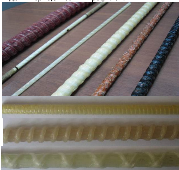
Рис. 1. Внешний вид периодических профилей композитной арматуры различных производителей
