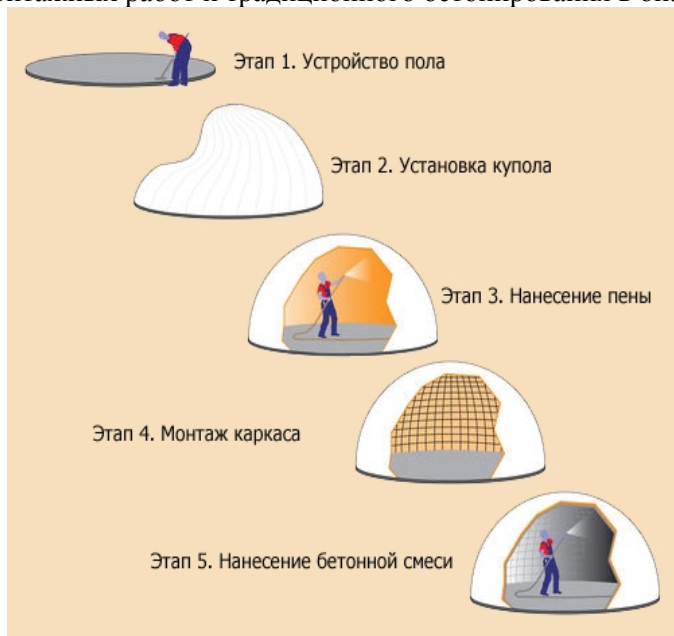
Рисунок 1. Этапы возведения купольного сооружения
