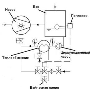
Рисунок 3 – Схема подключения рабочей жидкости с полной рециркуляцией
