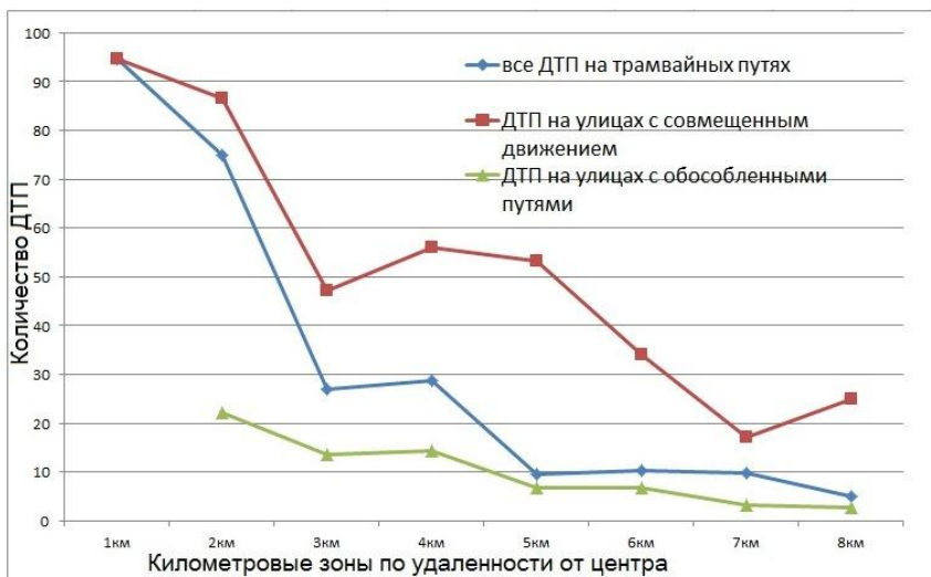
Рисунок 3 – Изменение количества ДТП на трамвайных путях на 1 км сети в зависимости от километровой зоны удаленности от центра
