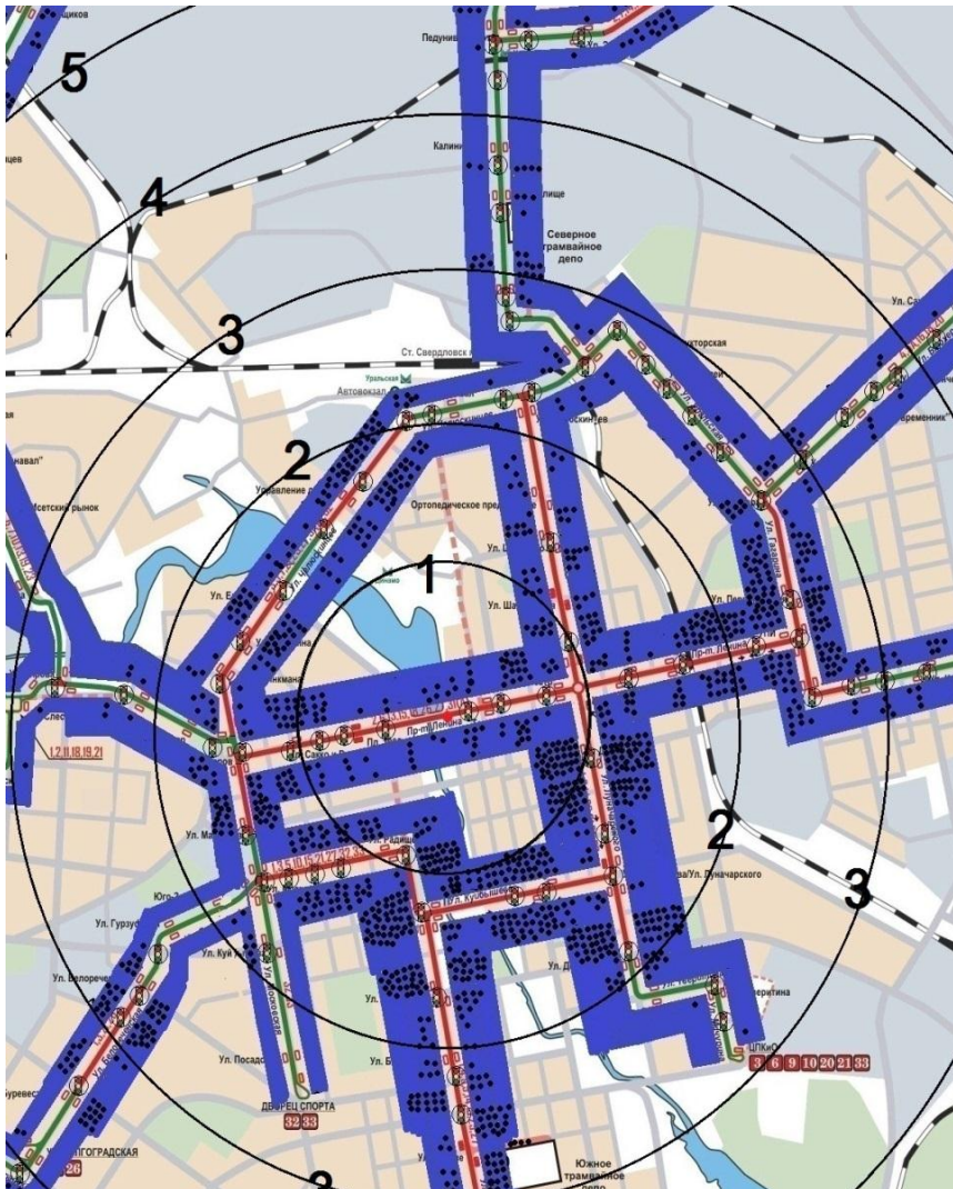
Рисунок 2 – Анализ мест концентрации ДТП на трамвайных путях в зависимости от удаления от центра (фрагмент центральной части города)
