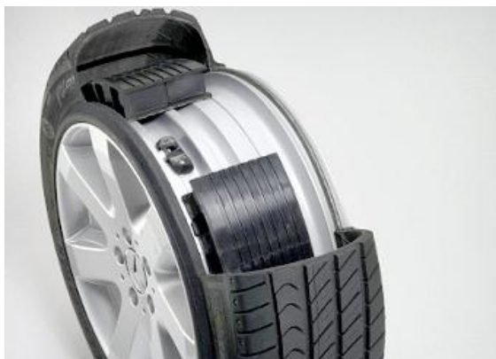
Рисунок 3 – Шина RunFlat с поддерживающим кольцом
