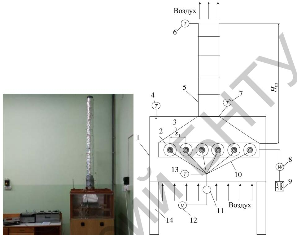
*Рис. 1. Фотография и схема экспериментального стенда для исследования свободной и смешанной конвекции: 1 – камера; 2 – однорядный горизонтальный пучок; 3 – диффузор; 4 – лабораторный термометр; 5 – вытяжная шахта; 6 – медь-константановая термопара; 7 – медь-константановая гипертермопара; 8 – ваттметр; 9 – масляный трансформатор; 10 – термопара; 11 – переключатель; 12 – вольтметр; 13 – сосуд Дьюара; 14 – опора*
