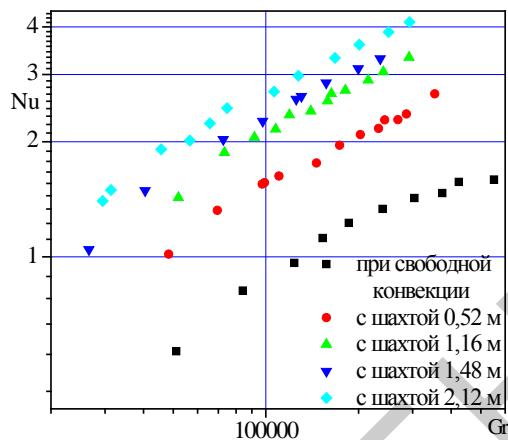
Рис. 3. Интенсификация теплоотдачи пучка воздействием вынужденной конвекцией
