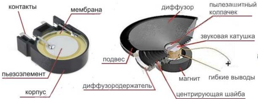
Рисунок 2 – Устройство пьезоизлучателя и динамика
