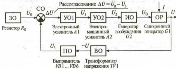
Рисунок 7 - Функциональная схема САР: ОР-объект регулирования; ИО-исполнительный орган; УО1,УО2-усилительные органы 1 и 2; ВО-воспринимающий орган; ПО- преобразующий орган; СО- сравнивающий орган ; ЗО-задающий орган
