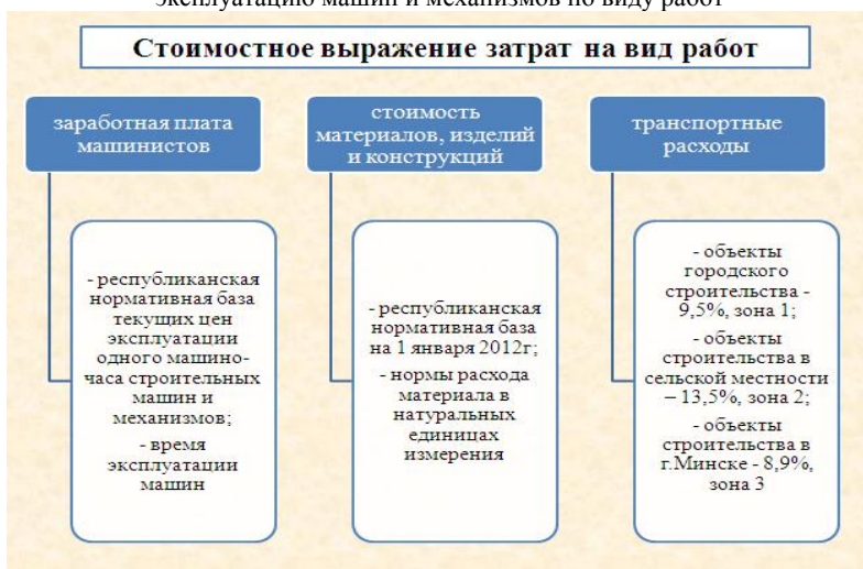
Рис. 2 – Стоимостное выражение затрат на заработную плату машинистов, материалы, изделия, конструкции и транспортные расходы
