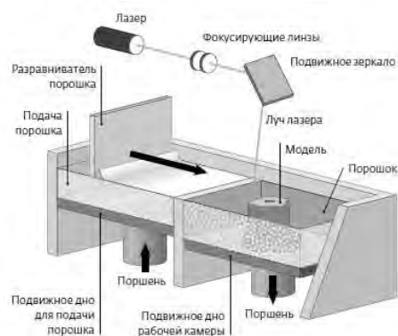
Рис. 1. Схема процесса СЛС
