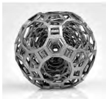
Рис. 2. Металлическая деталь, выращенная СЛС
