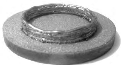
Рис. 9. Внешний вид полученного образца (ПГ-СРЗ, ПР-19М-01)
