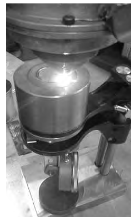
Рис. 6. Лазерное спекание слоя
