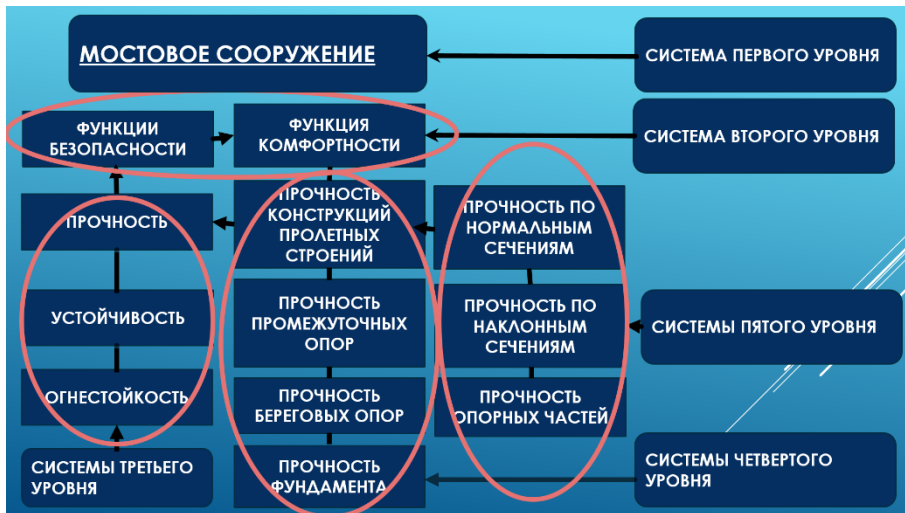
Рисунок 1 – Иерархия мостового сооружения как технической строительной системы
