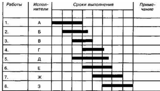
Рис.2.9 Ленточный график контроля выполнения комплекса работ
