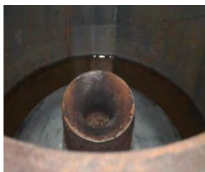
Рисунок 2 – Гранулятор с вертикальной осью вращения
