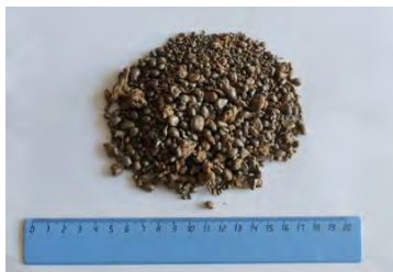
Рисунок 5 – Общий вид гранулированного чугуна
