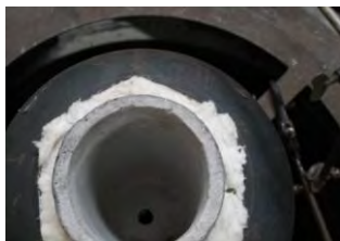
Рисунок 3 –Теплоизолированный приемный тигель с отверстием в донной части
