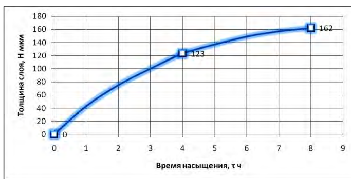
Рисунок 2 – Влияние времени комплексного порошкового азотирования на толщину диффузионного слоя на стали 5Х3В3МФС при температуре ХТО 560 °С
